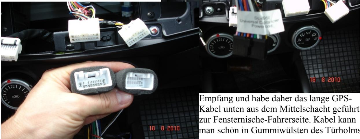
Empfang und habe daher das lange GPS-Kabel unten aus dem Mittelschacht geführt hin zur Fenstermitte-Fahrerseite. Kabel kann man schön in Gummiwülsten des Türholms
