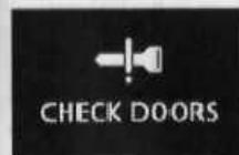
Wenn Sie bei Zündschalterposition "LOCK" (PUSH OFF) versuchen, die Türen und die Heckklappe durch Drücken auf einen der Verriegelungsschalter zu verriegeln, während eine Tür oder die Heckklappe nicht vollständig geschlossen ist, erscheint die Warnanzeige und der Summer ertönt für 3 Sekunden. Die Türen sowie die Heckklappe lassen sich in diesem Fall nicht verriegeln.
