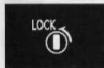
Wenn Sie bei einer Zündschalterposition außer "LOCK" (PUSH OFF) alle Türen sowie die Heckklappe schließen und versuchen, das Fahrzeug durch Drücken eines der Verriegelungsschalter von außen zu verriegeln, erscheint eine Warnanzeige und der Summer ertönt für drei Sekunden. In diesem Fall können Sie die Türen und Heckklappe nicht verriegeln.
