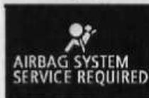
Die Warnleuchte/-anzeige spricht bei einem Defekt im System an. Darüber hinaus wird die Warnanzeige in der Informationsanzeigemasken des Multi-Informationsdisplays angezeigt.
