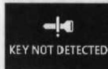
Wird das Fahrzeug geparkt und der Zündschalter befindet sich in einer anderen Stellung als "LOCK" (PUSH OFF), wird eine Warnung angezeigt und der Summer ertönt 4 Mal, wenn Sie die Tür nach dem Öffnen einer der Türen schließen und den Schlüssel des elektronischen Zugangs- und Startsystems aus dem Fahrzeug nehmen.
