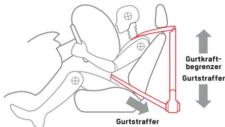
Bei einer Notbremsung werden die Warnblinklichter automatisch eingeschaltet, um nachfolgende Fahrer zu warnen. Weiteren Schutz geben die Sicherheitsgurte der Vordersitze mit Gurtstraffern und Gurtkraftbegrenzern. Das maximiert die Sicherheit und minimiert die Aufprallenergie für die Passagiere.
